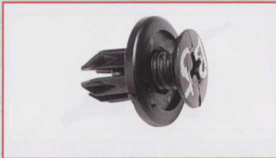
CIVIC K700/K800 '94-'99 水箱罩固定扣組 Grille Clip 91503-SP0-003
